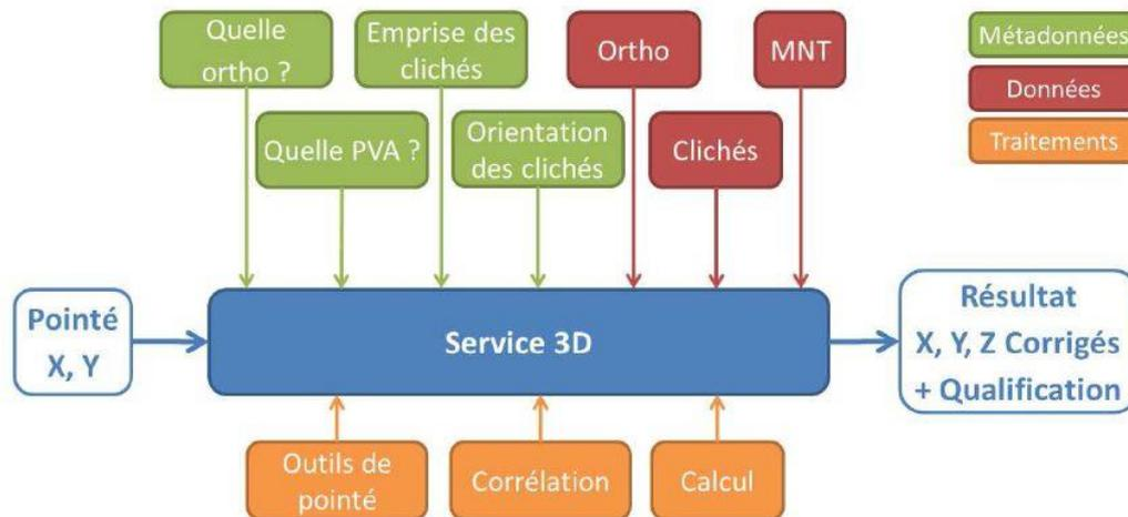
8. En vous aidant du schéma ci-dessus, veuillez décrire complètement le logigramme permettant, à partir d'un détail caractéristique pointé sur l'orthoimage, d'aboutir de façon automatique et en quasi temps réel à ses coordonnées 3D qualifiées.
