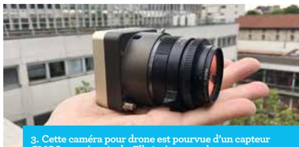
3. Cette caméra pour drone est pourvue d'un capteur CMOS 20 mégapixels. Elle intègre un obturateur électronique global, un module GPS et une carte mémoire.
