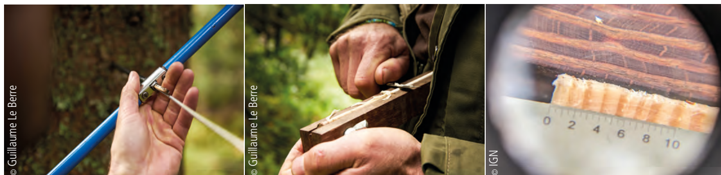
Figure 2 : Carottage d'un arbre, préparation de la carotte de bois et mesure des cernes de croissance les plus récents
