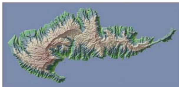
MNT de l'île d'Hiva Oa (Polynésie française), issu de la restitution photogrammétrique de couples stéréoscopiques IKONOS ©SAU 2008
