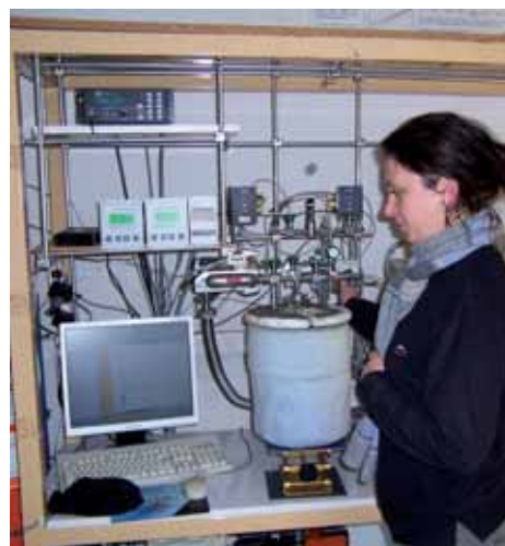
► Spectromètre de masse à rapport isotopique Finnigan MAT253, dédié aux mesures atmosphériques et aux carottes de glace (à gauche). Appareil dédié aux mesures de dioxyde de carbone (à droite).
