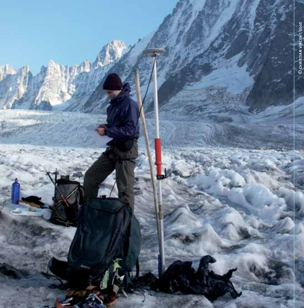
► Mesures GPS sur le glacier d'Argentière pour déterminer les vitesses d'écoulement du glacier à partir de balises implantées en profondeur dans la glace.
