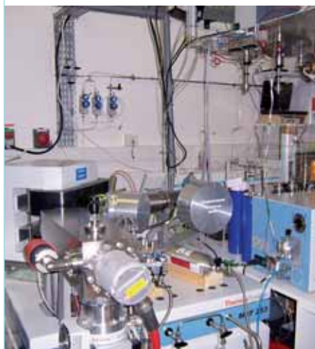
► Spectromètre de masse à rapport isotopique Finnigan MAT253, dédié aux mesures atmosphériques et aux carottes de glace (à gauche). Appareil dédié aux mesures de dioxyde de carbone (à droite).
