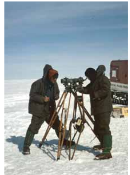
➤ Etalonnage des théodolites au cours de l'Expédition glaciologique internationale au Groenland, en 1968.
